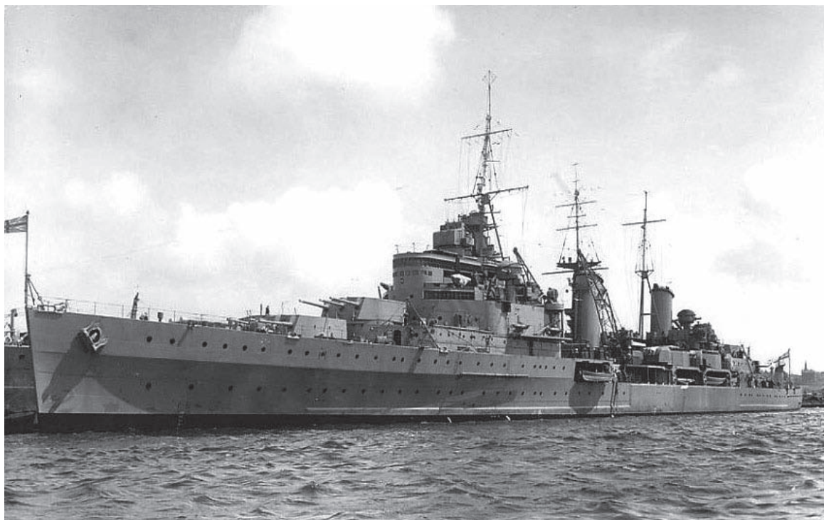
Легкий крейсер «Эдинбург». Построен: 1939 г., Swan Hunter, Wallsend. Водоизмещение: 12 675 т. Основные размеры: 187 x 19, 5 x 7 м. Мощность силовой установки: 80 000 л. с. Скорость: 32, 5 узла. Вооружение: 4 орудийные башни главного калибра 152 мм, 20 орудий калибра 100 мм, 8 торпедных аппаратов, скорострельные зенитные установки, 4 гидросамолета. Экипаж: 750 чел.
