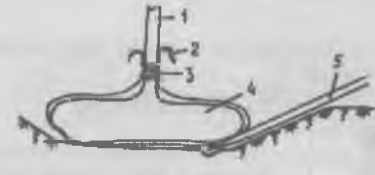
Рис. 2. Схема упаковки кома земли при выемке дерева
