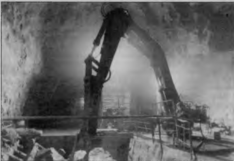
Дробление негабаритов установкой "Rammer".
