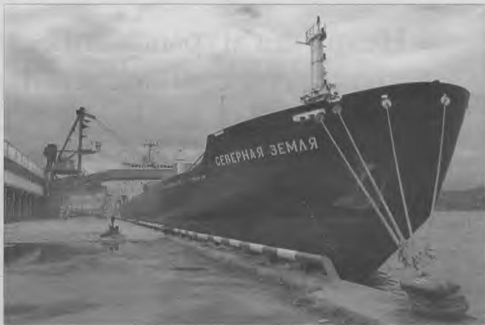
"Северная Земля" - судно ледового класса, предназначенное для перевозки всего спектра навалочных и генеральных грузов.
