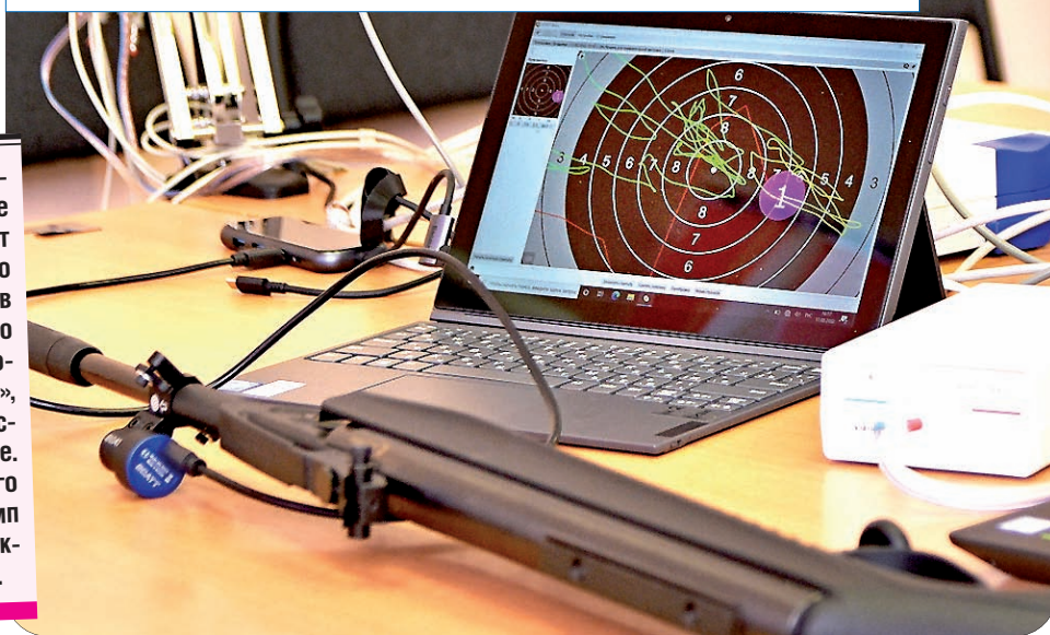
Система «Скат» отслеживает все движения винтовки до и после выстрела.
