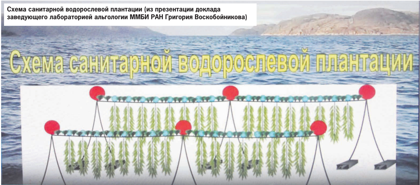
«Биомат» для очистки придонных слоев морской воды (из презентации доклада заведующего лабораторией альгологии ММБИ РАН Григория Воскобойникова)
